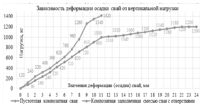
Рис. 3. График зависимости деформаций осадки композитных свай от прилагаемой вертикальной нагрузки (сравнение показателей первого и второго опытов)
