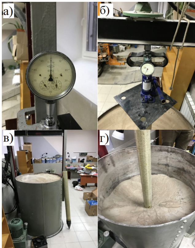
Рис. 1. Оборудование и материалы перед испытанием: а) измеритель деформации (прогибомер Аустова); б) металлическое навершие (оголовок) верхней части сваи; в) емкость с песчаным грунтом; г) погруженная в грунт полая композитная свая перед испытанием.
