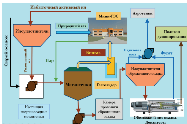
Рисунок 2 – Схема обработки осадка в плане реконструкции ОСК 2009 г. (II очередь)
