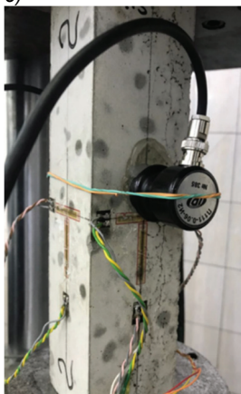
Рисунок 1 – Определение параметрических точек трещинообразования: а) схема расположения приборов, б) испытываемый образец.
