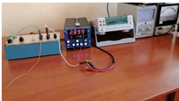
Рис. 1– Используемые вольтметры и формирователь сигналов ЛАТР
