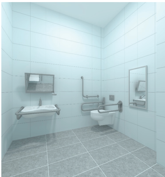
Рисунок 3. Специфика оборудования санузла для инвалидов
